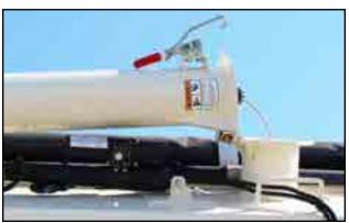
Fig 41 - Auger tube hinge
