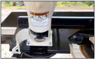
Fig 38 - Auger tube access door
